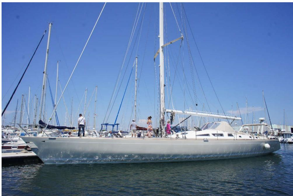
**Tànana un voilier exceptionnel !** Un voilier de course et de croisière dessiné par Gilles Vaton, sa coque de 24 mètres en aluminium renforcée en fait un voilier rapide et sûr. Propulsé par 280m<sup>2</sup> de voile et appuyé par un moteur de 250ch turbo qui permet d'affronter toutes les conditions sereinement.
